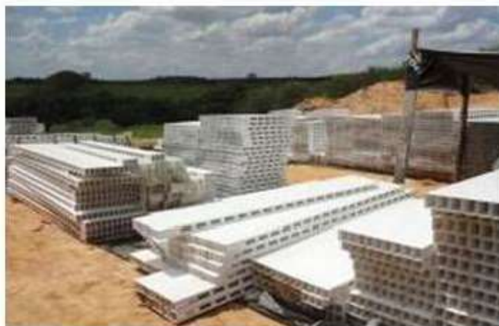
FIGURA 10 – Painéis de PVC pré-moldados na fábrica
